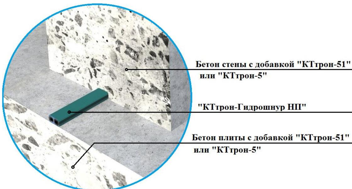
При бетонировании часто возникают дефекты по примыканиям. То цементное молочко убежит, то трещины проявятся из-за недостаточно качественной подготовки поверхности. «Завод «КТТрон» рекомендует произвести штрабление вдоль примыкания, с последующей зачеканкой шовным ремонтным материалом «КТТрон-2»
